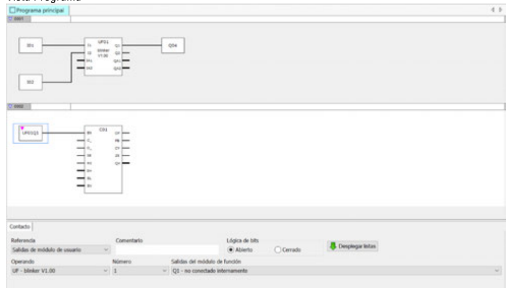
Fig. 279: Cableado de las entradas/salidas
