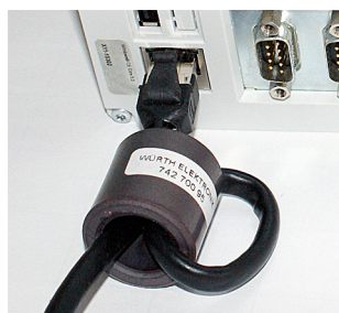
Abb. 34 Ethernetkabel, Schlaufe 2-fach durch Ferrit
