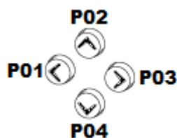
Rys. 113: Przyciski kursora są przewodowane na schemacie programu jako P 01 do P 04.
